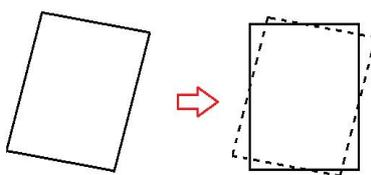
**背景填充方式：**可将图像中的背景黑色（黑色边框）自动填充为白色。根据填充方式，可选择凸多边形填充和凹多边形填充；填充的背景颜色可选择智能识别文稿底色或固定白色。
