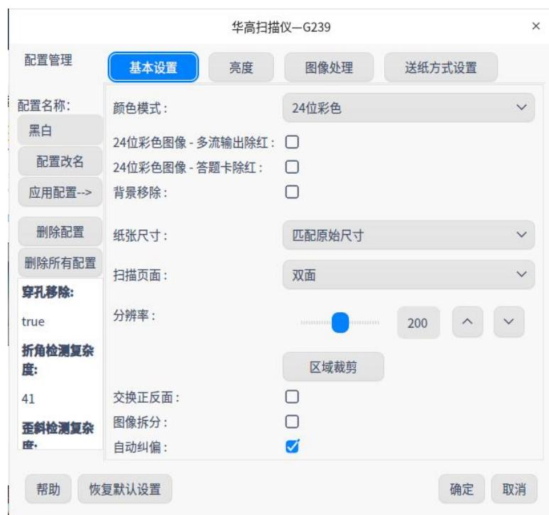
扫描参数具体使用方式，请参见《扫描参数设置帮助手册》。可通过点击对话框下方的“帮助”按钮弹出此手册。
