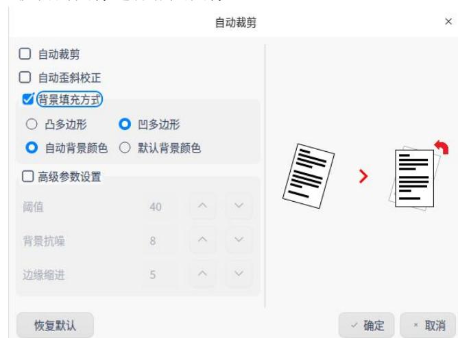
**自动裁剪:** 判断图像中真实文稿的边缘并自动对图像进行裁剪，使得图像贴合文稿真实边缘。
