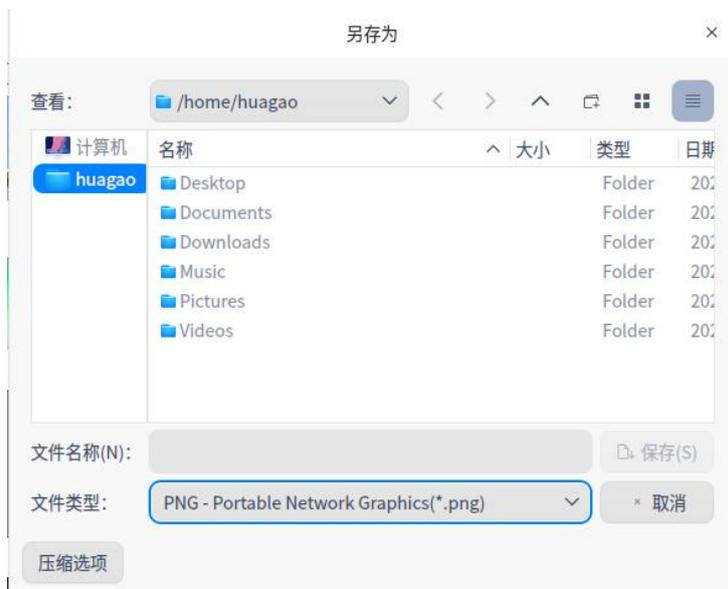
**E. 导出：**弹出导出对话框，可将列表中的指定页面保存到指定目录。支持的导出格式为：JPG(\*.jpg)、BMP(\*.bmp)、PNG(\*.png)、TIFF(\*.tif)、PDF(\*.pdf)、OFD(\*.ofd)。
