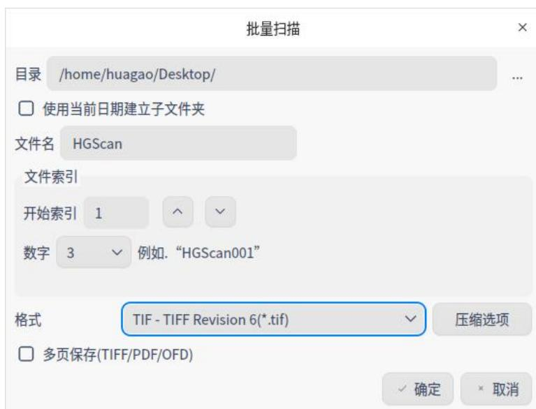
设置好参数后，点击“确定”按钮，扫描仪将进行批量扫描。扫描到的图像都将自动储存在指定的目录中。
